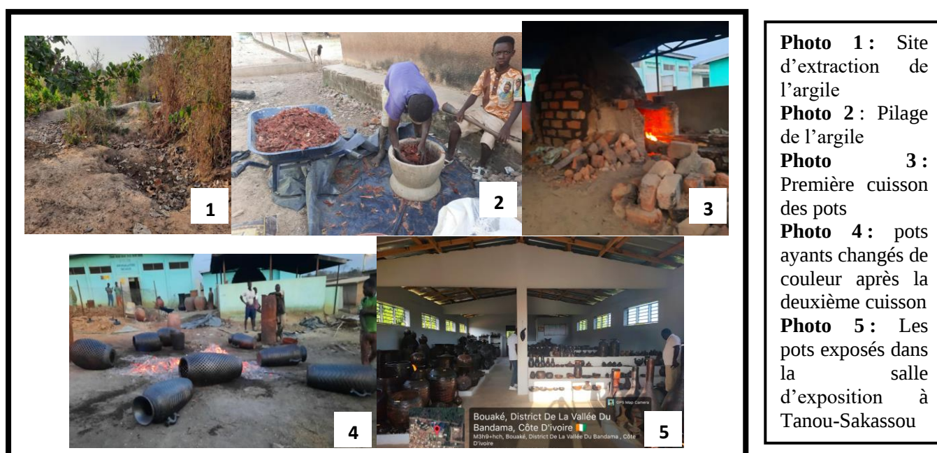
Planche photographique 1 : Processus de fabrication des pots de l'extraction de l'argile à l'exposition
